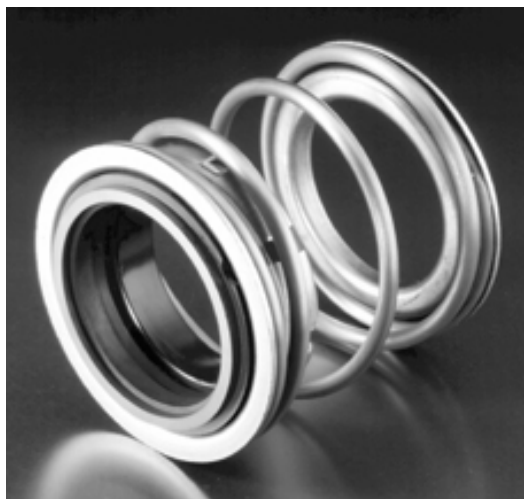
Figur 4-6 Den roterande delen av axeltätningen. Fjäders trycker tätningssytan mot den fasta delen.
